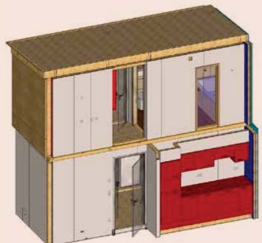
Module mit eingebauter Küche, Treppe und Bad
