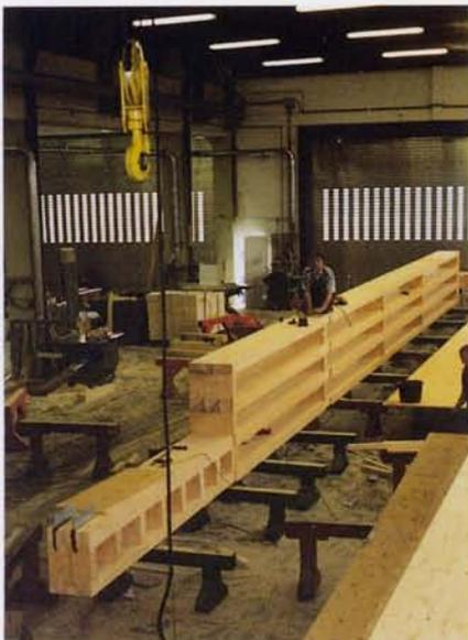
**Bild 2:** BS-Holz-Rippen und Füllhölzer bilden das Innenleben der Stützen und Träger: hier eine doppelt ausgeklinkte Stütze mit Schlitzblechen
