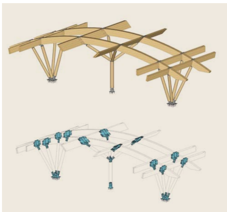
◀ Rundgefräste BS-Holz-Stützen, Bogenbinder und Querträger bilden das Tragwerk. Die Anschlüsse erfolgen über spezielle Stahlanschlussteile und -bleche (unten)
