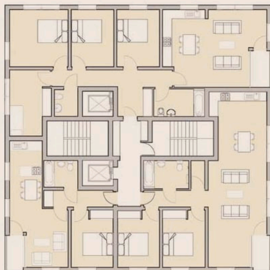
Grundriss auf 17,50 m x 17,50 m: Viele quer und längs angeordnete Wände steifen die Geschosse vertikal aus
