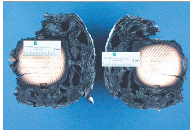
Schnitt durch den Probekörper nach der thermischen Belastung Foto: WKI
